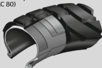
Le pneu ceinturé à plis en biais (TKC 80)
